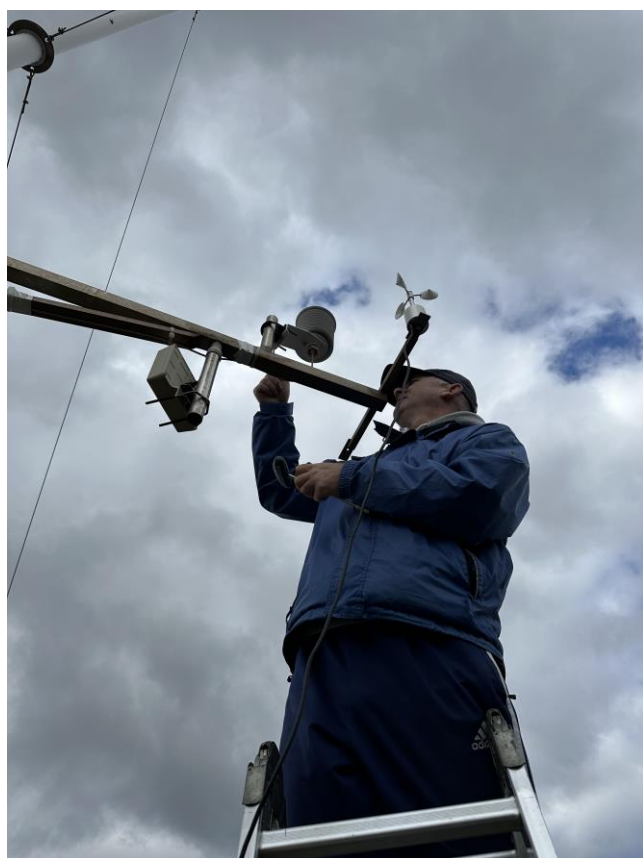
Εικόνα 1.2-2: Απο τις τεχνικές εργασίες αντικατάστασης ανεμόμετρου στον σταθμό ΖΚΤ-1.
